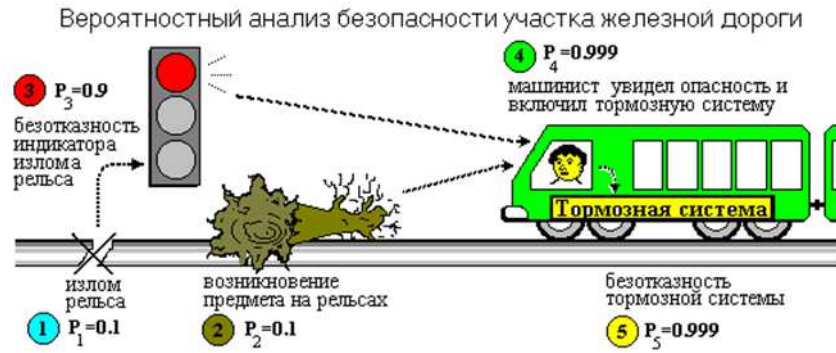
Рис. 7.1. Схема участка внутриплощадочных железнодорожных путей
