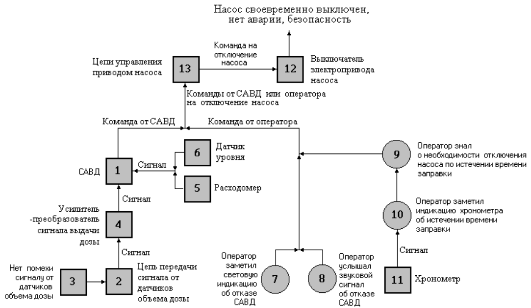
Рис. 12.2. Функциональная блок-схема безопасности заправочной операции
